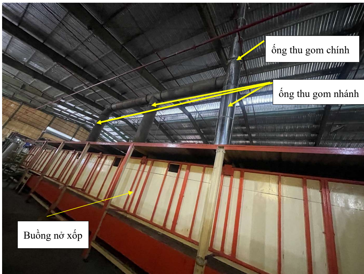
Hình 4.4: Hình ảnh minh họa của buồng chứa xốp nổ và hệ thống thu gom hơi hóa chất
