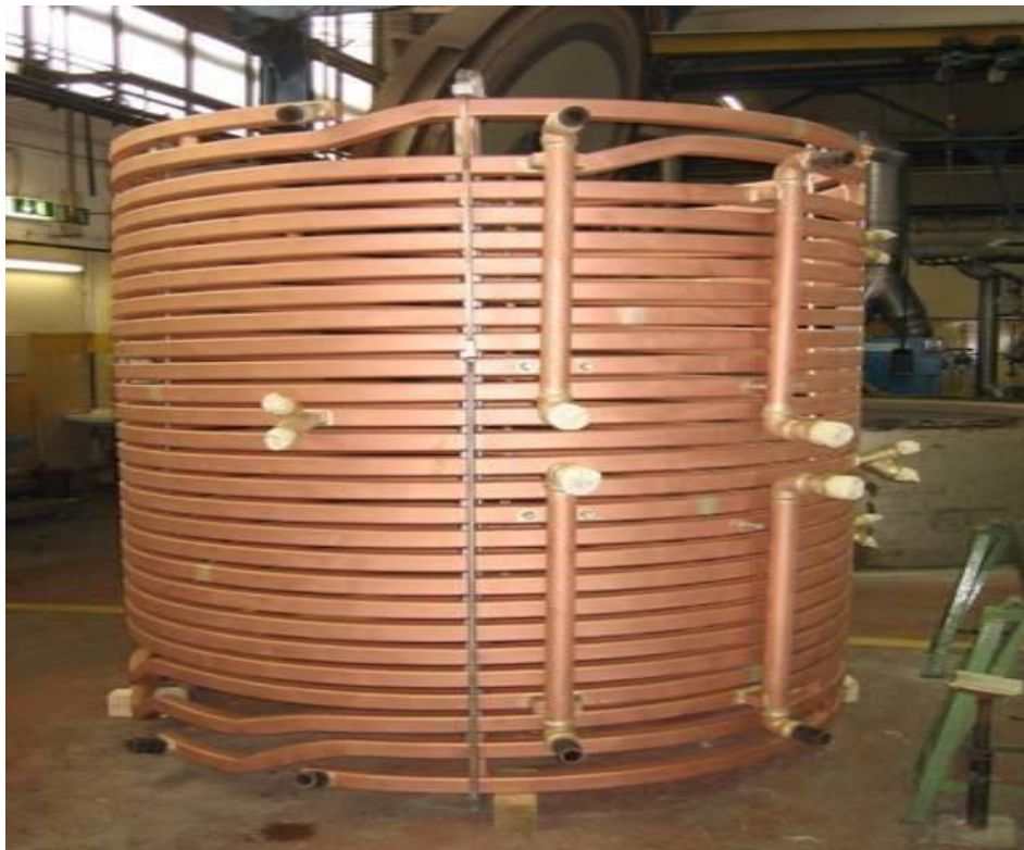
Hình 4.6. Đường ống đưa nước làm mát tại lò luyện phôi thép
