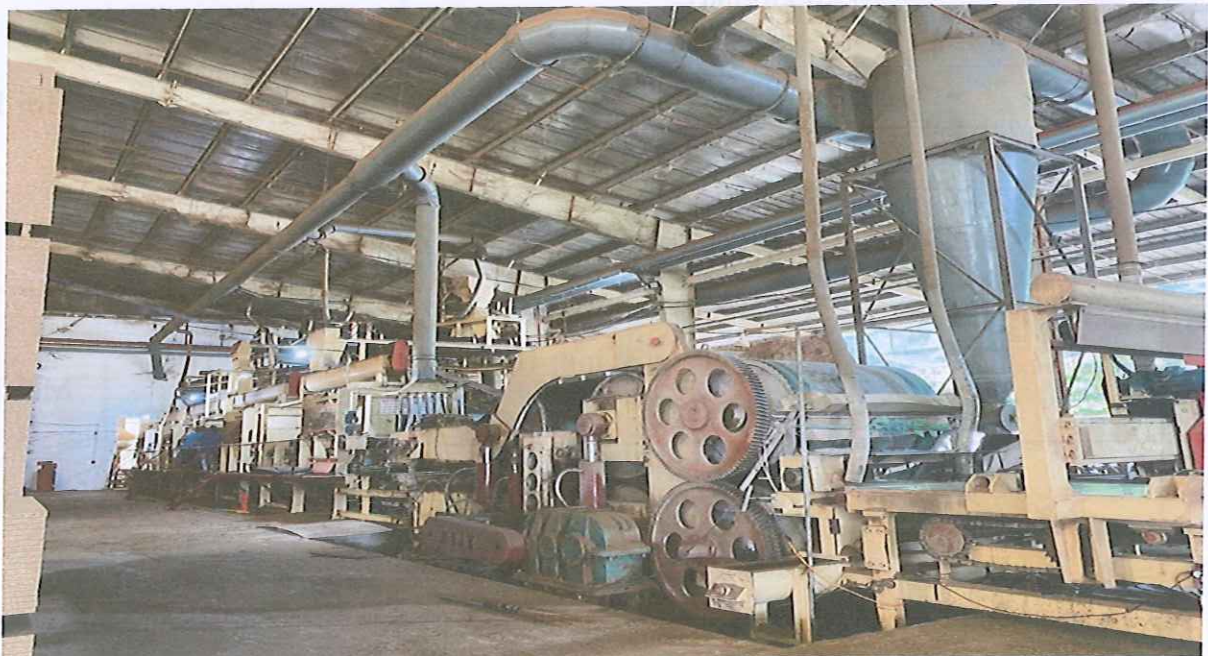
Hình 1.5. Máy rải dăm và ép thành tấm
