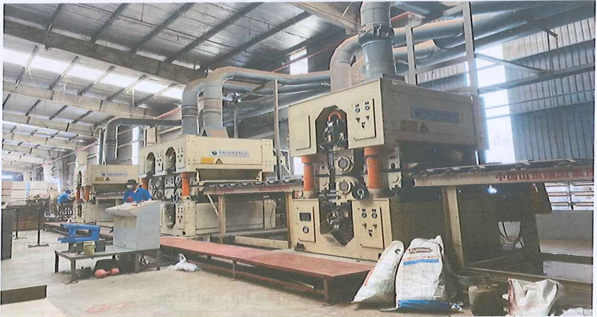
Hình 1.4. Máy chà cho nhẵn bề mặt tấm ván
