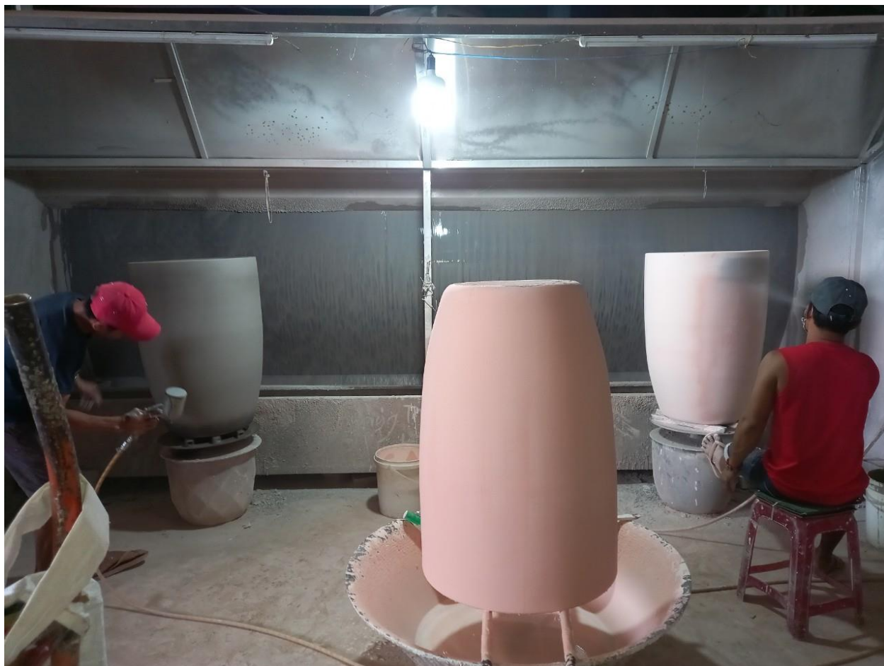
Hình 4. 7. Hệ thống màng nước hấp thụ bụi men tại công ty d). Biện pháp giảm thiểu khí thải từ quá trình vận hành lò nung đốt củi
