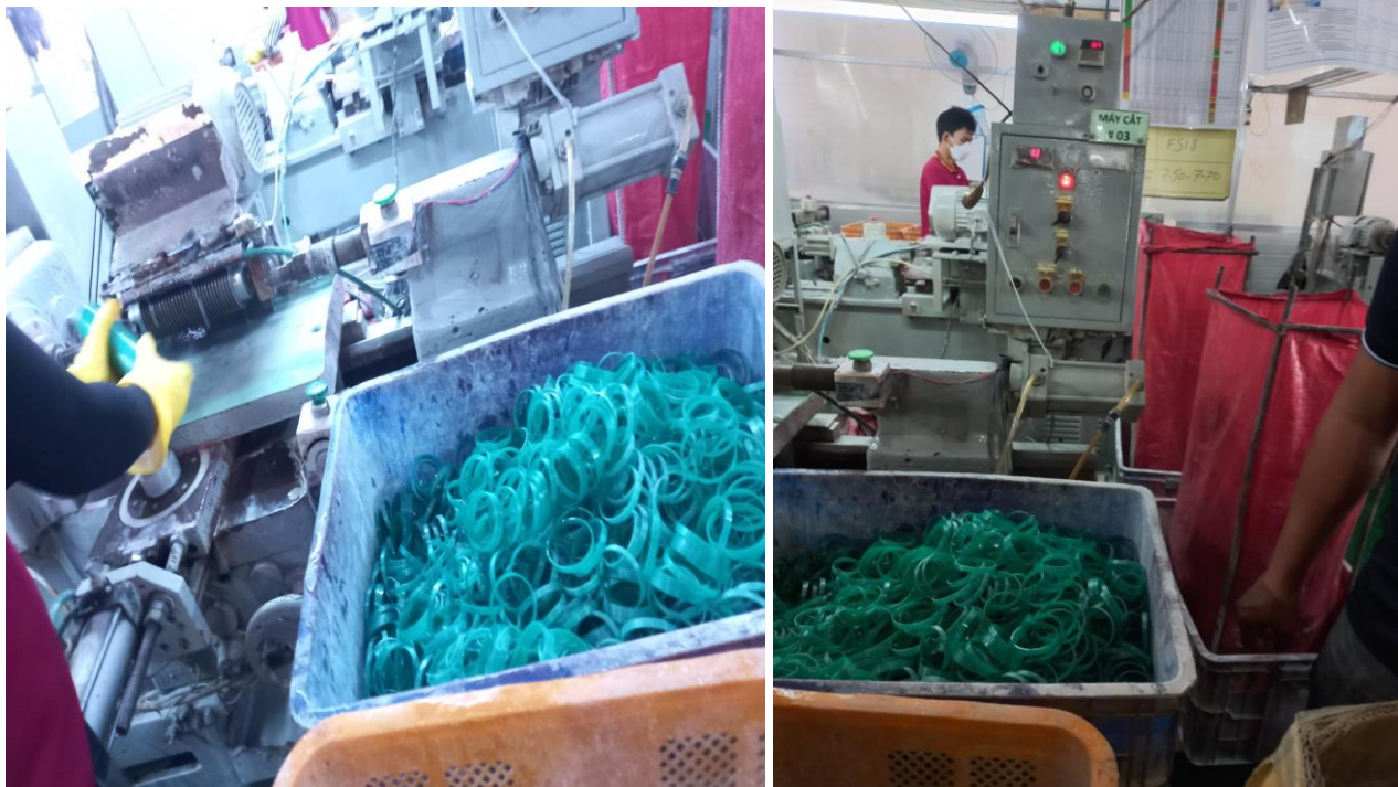
Hình 3. 7. Hình ảnh máy cắt ống thủy tinh kèm thiết bị xử lý bụi bằng cách phun nước
