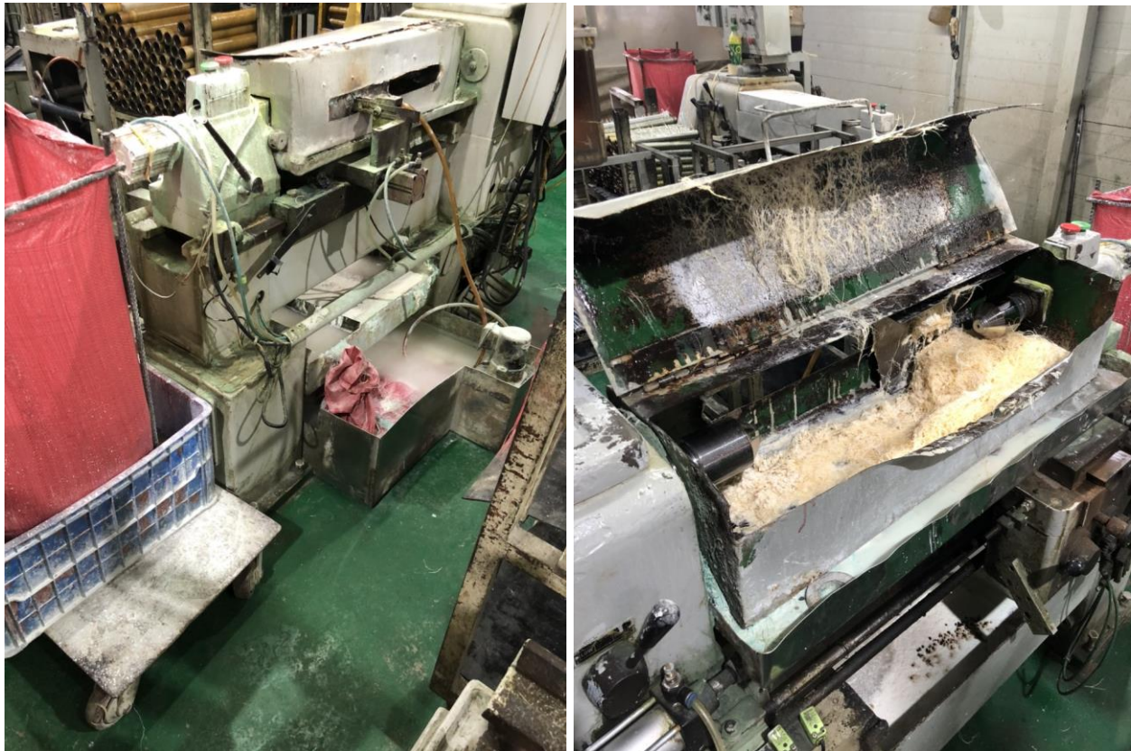
Hình 3. 5. Hình ảnh máy tiện kèm thiết bị xử lý bụi
