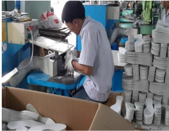
Công đoạn mài cạnh
