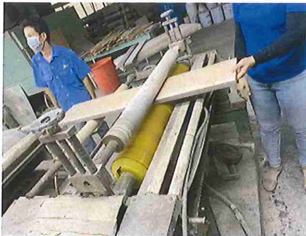
Hình 1. 12. Công đoạn cán sơn lót và dây chuyền chà nhám, cán sơn tạo nền
