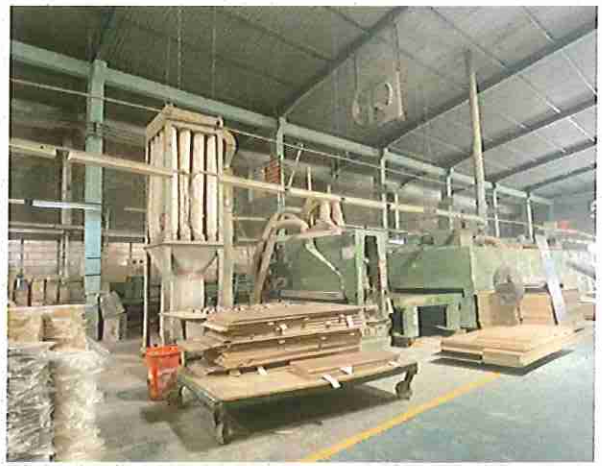
Hình 1. 12. Công đoạn cán sơn lót và dây chuyền chà nhám, cán sơn tạo nền
