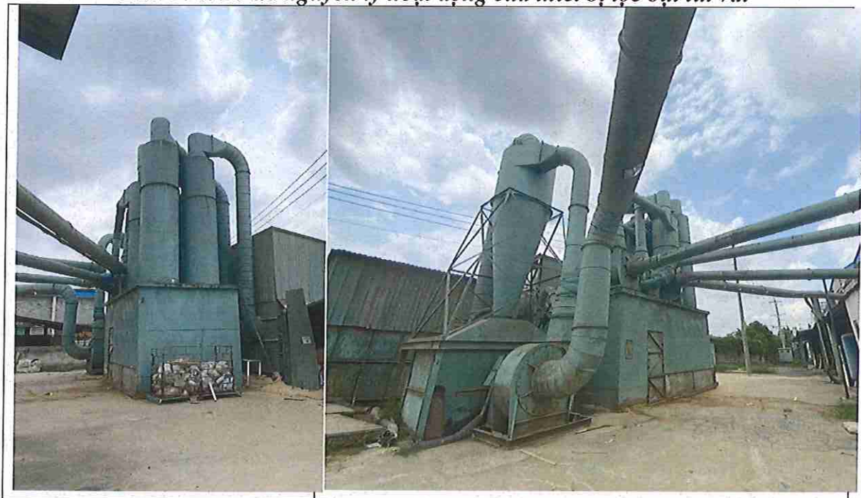
Hình 3. 9. Hệ thống cyclone và thiết bị lọc bụi túi vải
