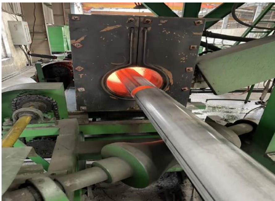
Hình 1.10. Quá trình sản xuất ống inox bằng phương pháp hàn
