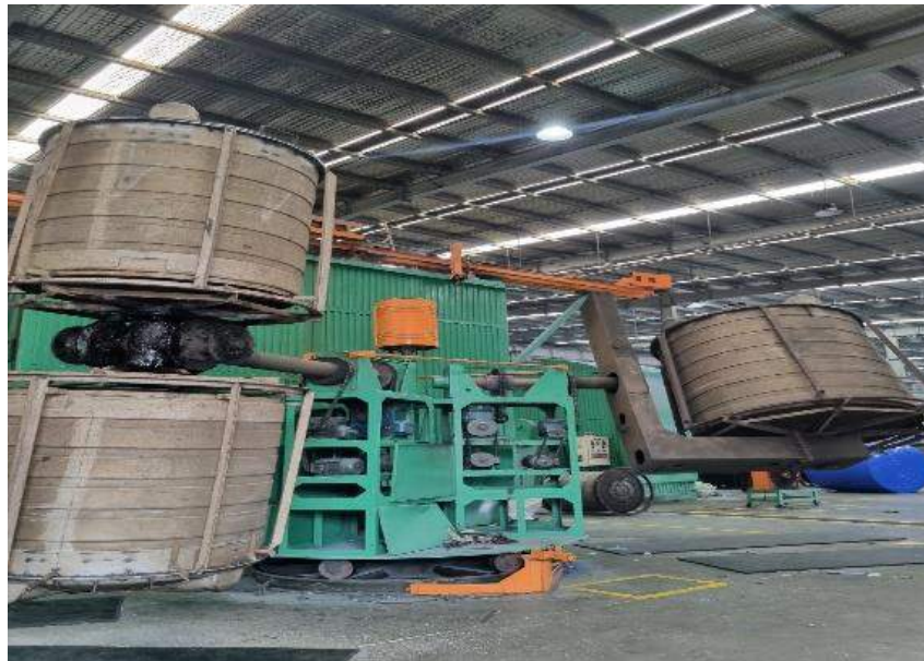
Hình 1.8. Hình ảnh minh họa hệ thống đổ khuôn bồn nhựa
