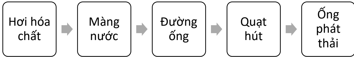
Hình 17 Công nghệ xử lý hơi dung môi bằng công nghệ màng phun nước hấp thụ
