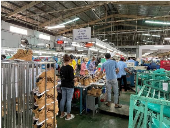
Công đoạn xỏ dây, phối đôi
