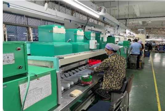
Công đoạn quét keo + sấy
