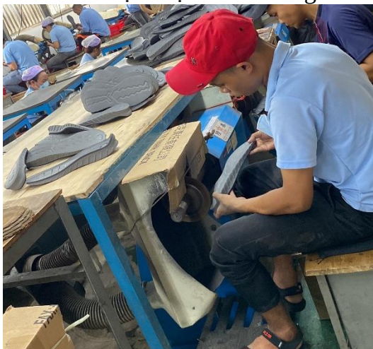
Khu vực mài đế có gắn hệ thống thu gom bụi đi kèm
