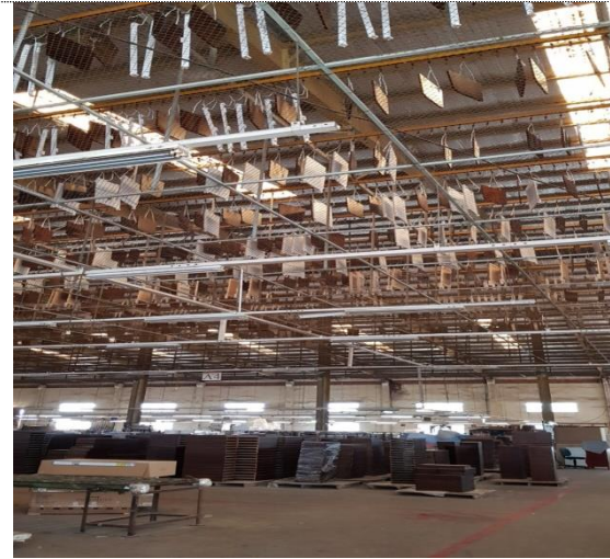
Chuyền sơn treo để khô sản phẩm
