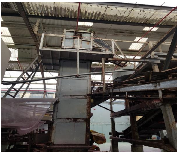
Gàu tải chuyển nguyên liệu từ chảo trộn liệu qua chảo chia liệu
