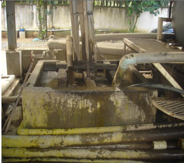
Hầm dẫn bột giấy lên giàn xeo giấy
