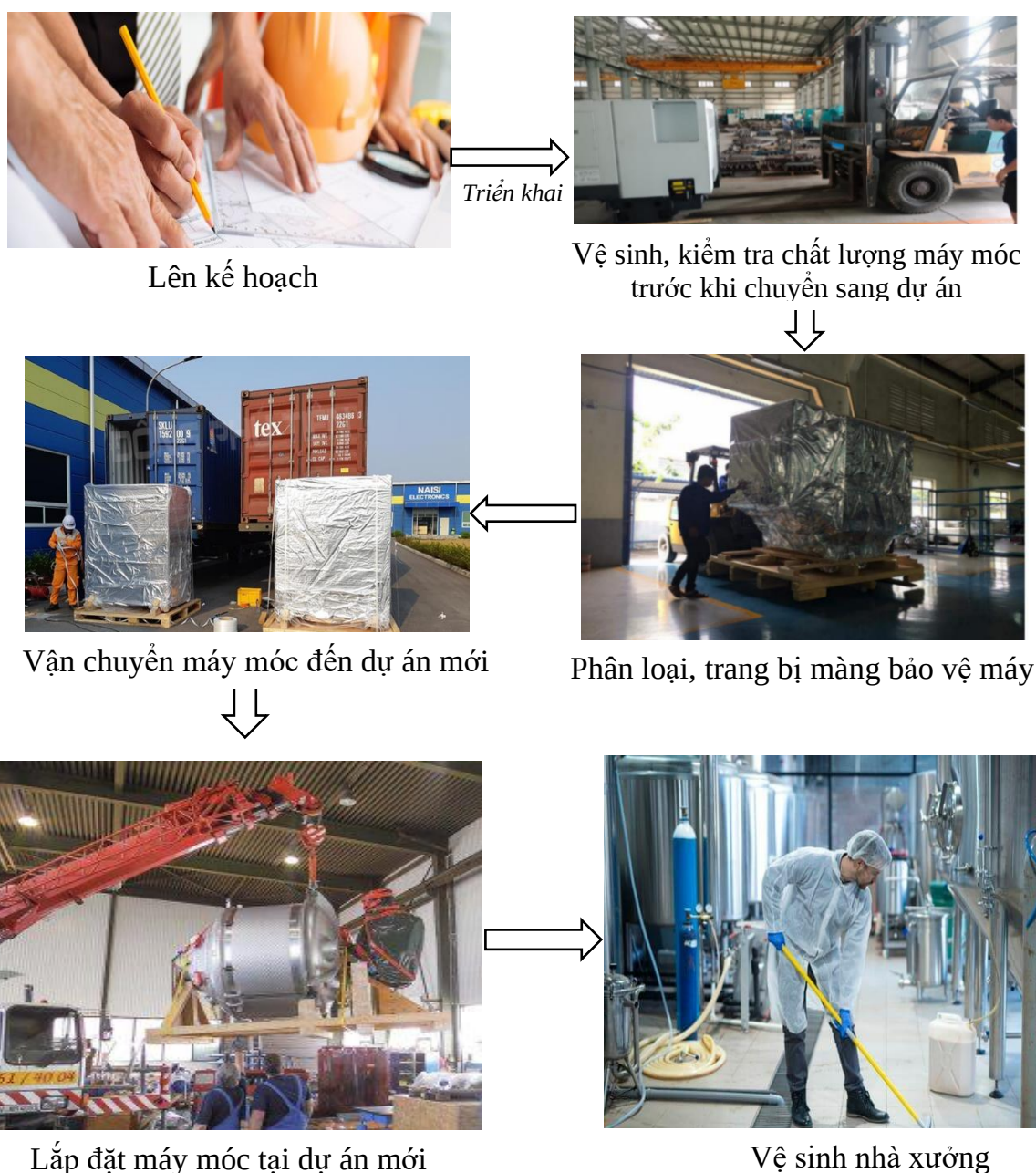
Hình 4. 1: Hình ảnh minh họa quy trình di dời máy móc từ nhà máy tại KCN VSIP II sang dự án
