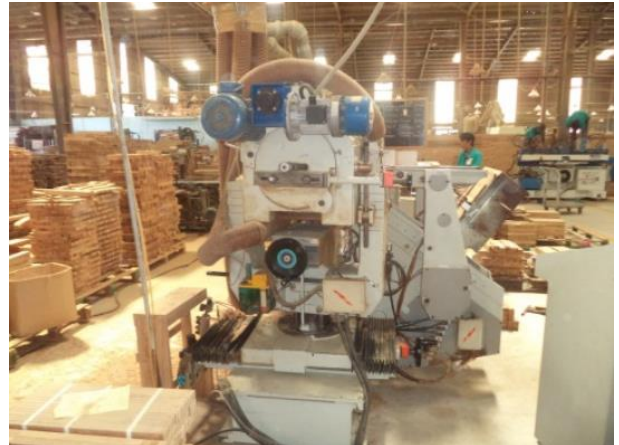
Hình 3. 9: Các máy móc thiết bị khu vực chà nhám được trang bị các đường ống hút bụi
