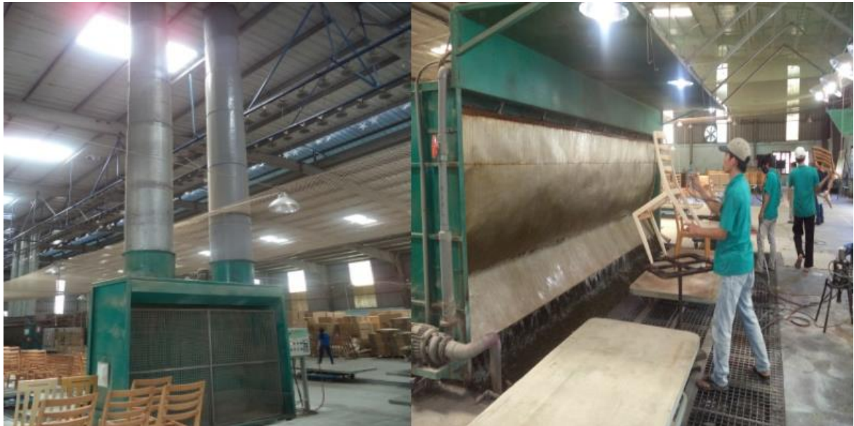
Hình 3. 8: Hình ảnh khu vực bồn sơn và hệ thống xử lý khí thải khu vực bồn sơn
