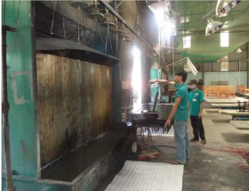
Hình 1. 6: Công đoạn phun sơn
