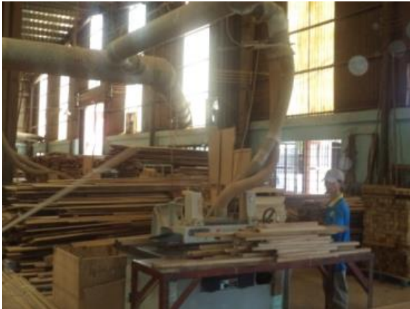
Hình 3. 9: Các máy móc thiết bị khu vực chà nhám được trang bị các đường ống hút bụi
