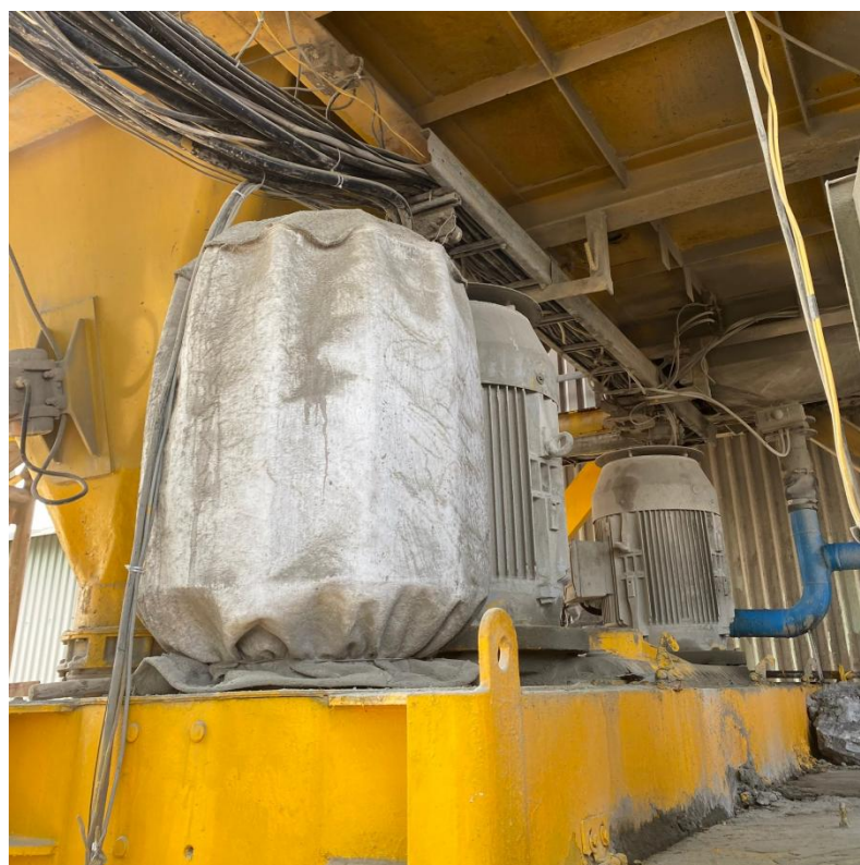
Hình 3.7. Hệ thống lọc bụi dạng túi vải của thiết bị trộn bê tông
