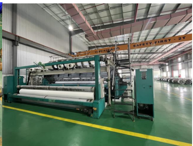
Công đoạn đan kết trong sản xuất vải sợi tổng hợp
