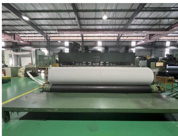
Công đoạn cuộn vải
