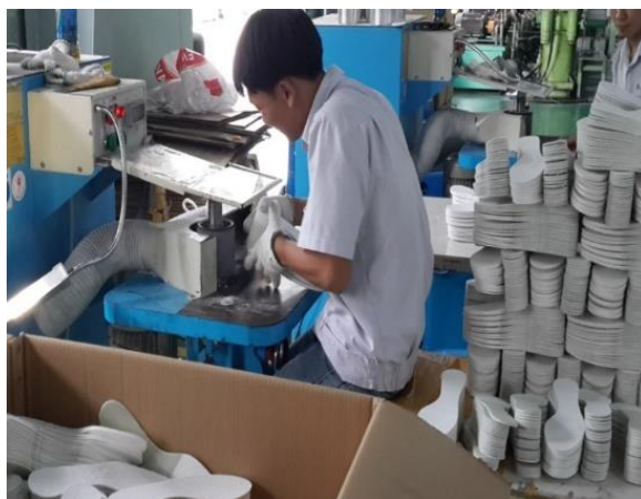
Công đoạn mài cạnh
