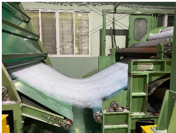
Công đoạn trải tấm trong sản xuất vải dệt kim
