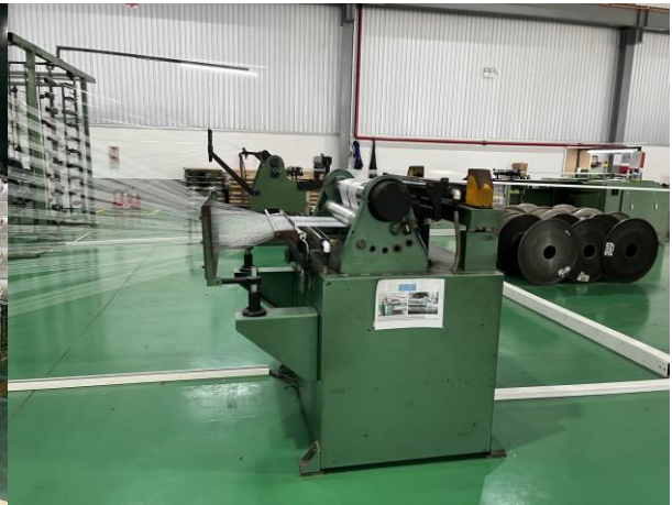
Công đoạn kéo sợi trong sản xuất vải sợi tổng hợp
