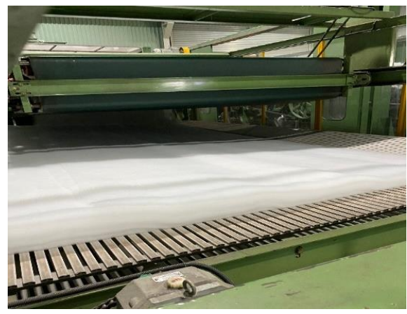
Công đoạn trải tấm trong sản xuất vải đan móc
