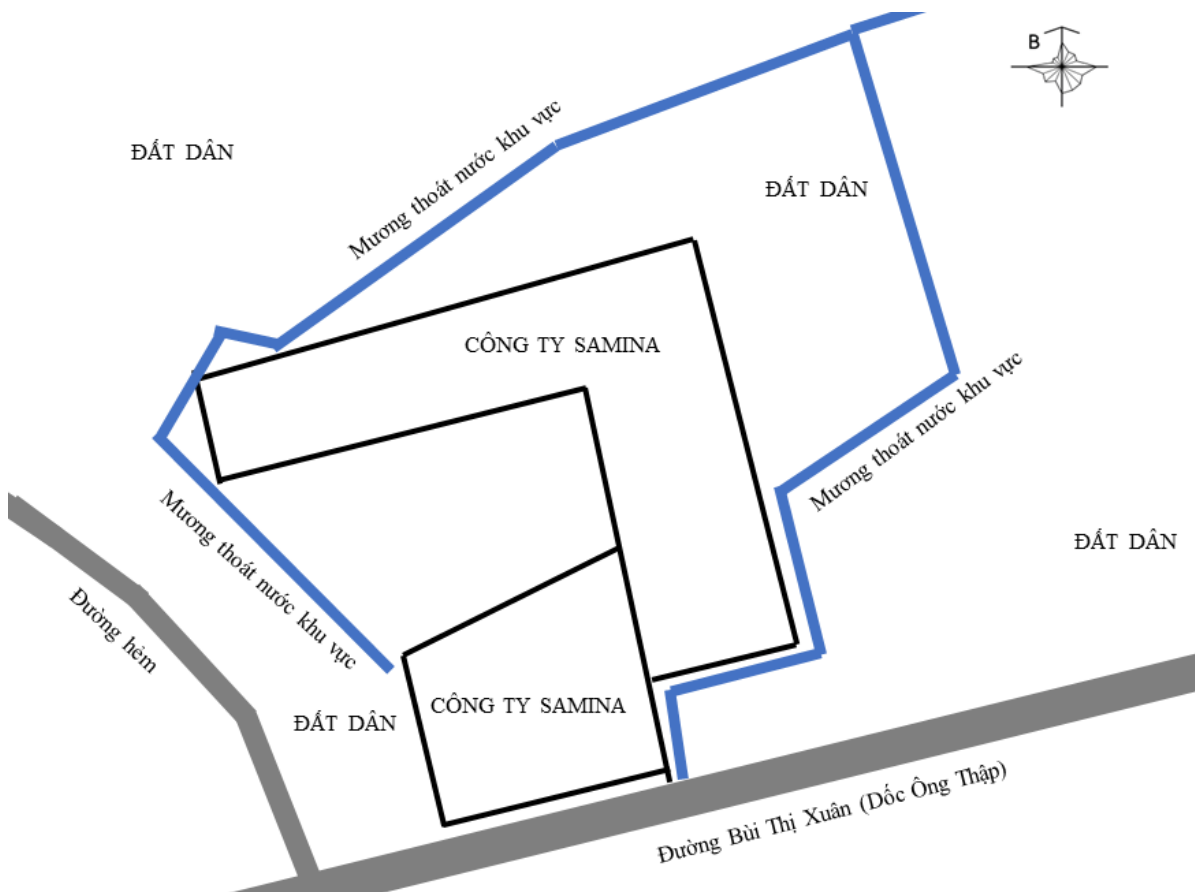
Hình 3. 1: Mương thoát nước của khu vực xung quanh cơ sở
