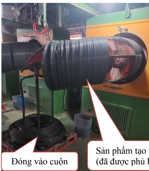
Máy duỗi kết hợp kéo lần 3, sử dụng bột bóng
