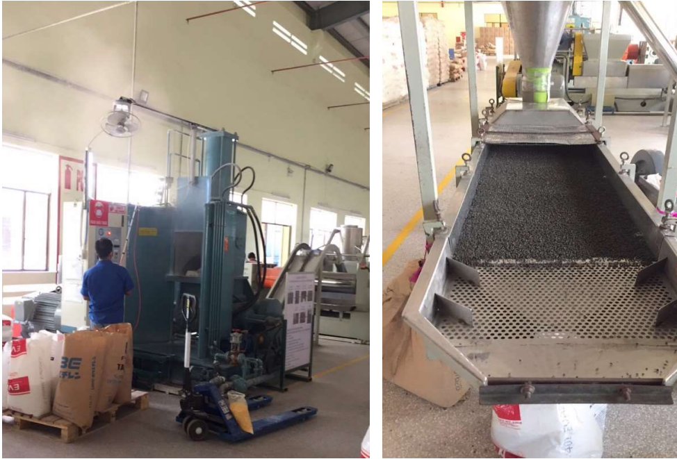
Hình 1.10. Công đoạn cán liệu và tạo hạt
