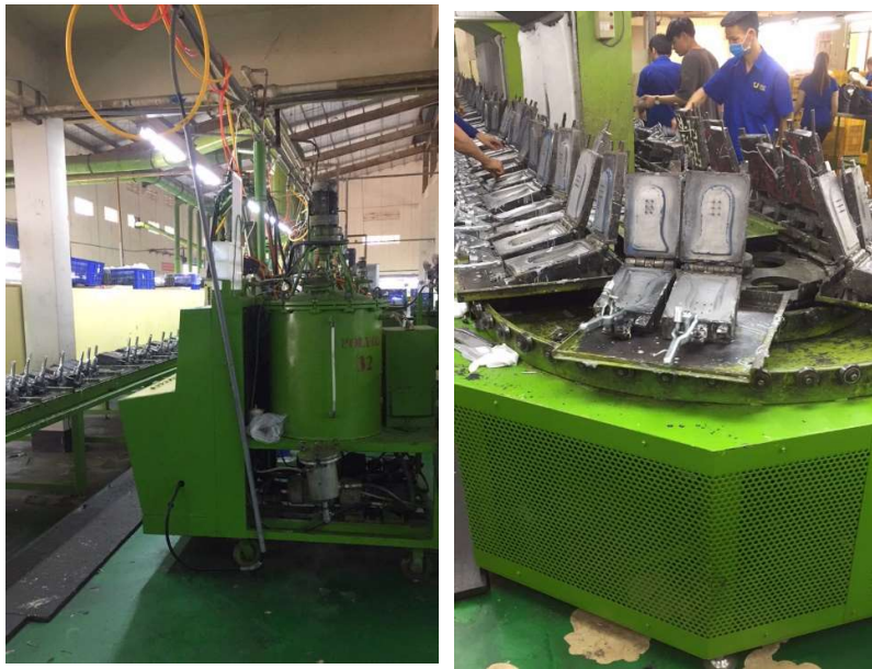
Hình 1.4. Công đoạn đổ khuôn, gia nhiệt tạo hình sản phẩm
