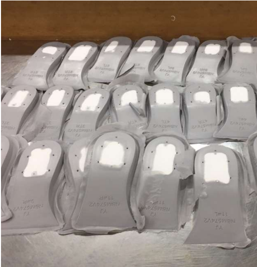
Hình 1.5. Sản phẩm mới ra khuôn và sau khi đã cắt tỉa bavaria, góc cạnh
