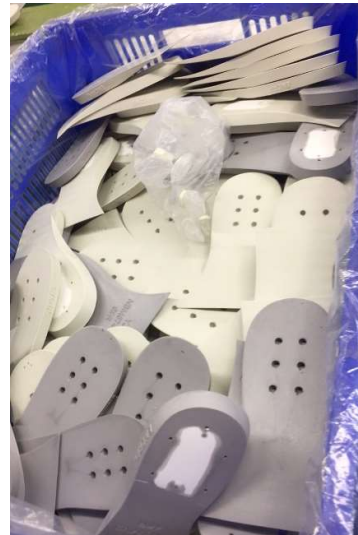
Hình 1.5. Sản phẩm mới ra khuôn và sau khi đã cắt tỉa bavaria, góc cạnh
