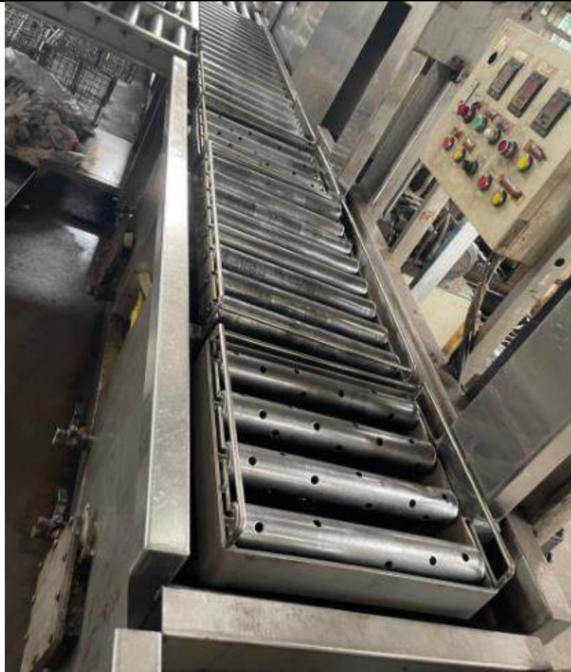
Hình 1. 6: Công đoạn nhúng dầu chống sét
