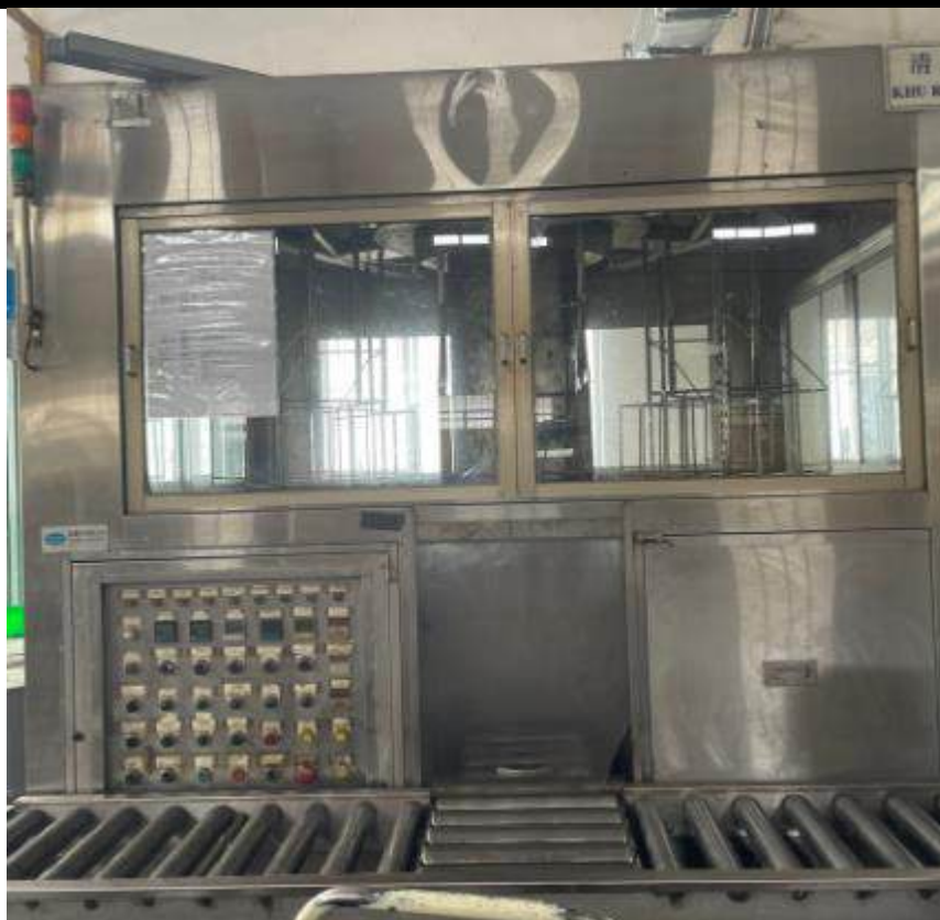
Hình 1. 7: Máy rửa sóng siêu âm tẩy dầu
