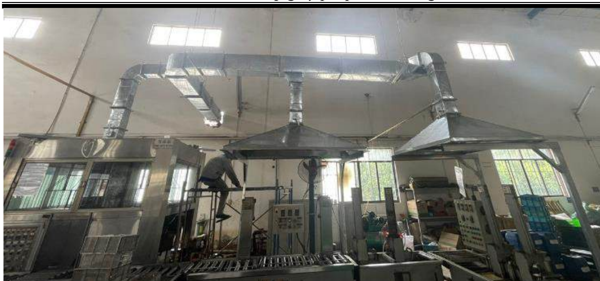
Hình 3. 20: Công đoạn tẩy dầu trên linh kiện, rửa nước, nhúng dầu chống sét và máy rửa sóng siêu âm
