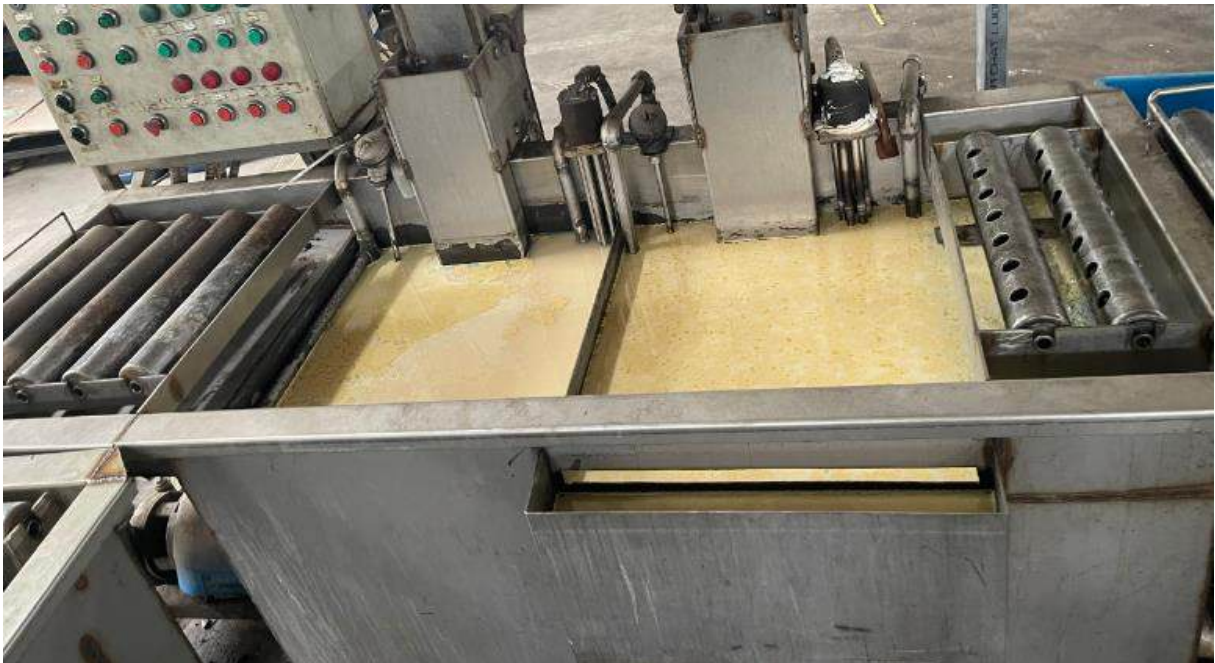
Hình 1. 4: Công đoạn tẩy dầu
