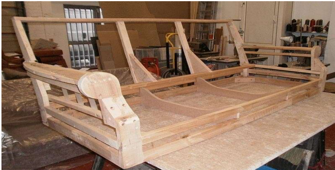
Hình 1.5: Khung kệ gỗ sau khi lắp ráp bằng đinh ốc, keo dán
