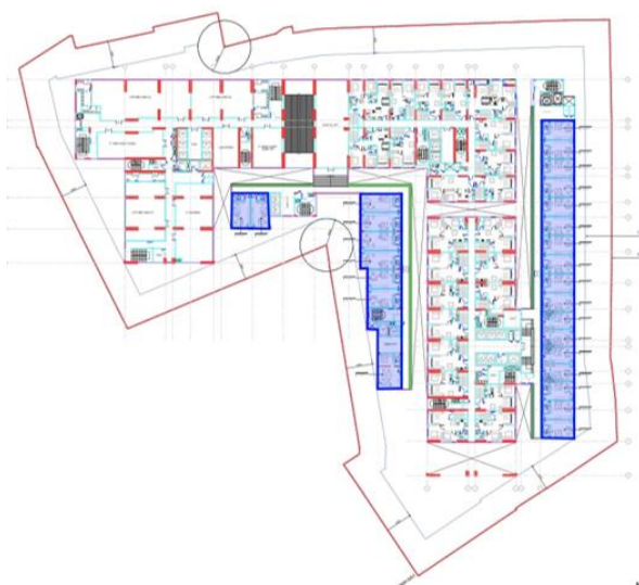
Hình 1. 10. Sơ đồ mặt bằng tầng 2 bố trí văn phòng kết hợp lưu trú (Officetel)
