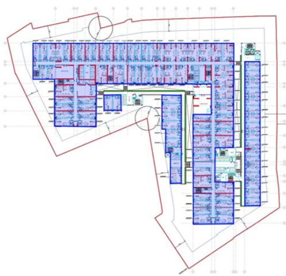
Hình 1. 13. Sơ đồ mặt bằng tầng 5 bố trí văn phòng kết hợp lưu trú (Officetel)
