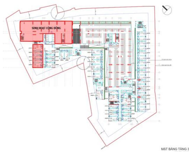
Hình 1. 19. Sơ đồ mặt bằng tầng 3 bố trí khu sinh hoạt cộng đồng
