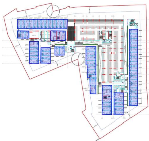
Hình 1. 12. Sơ đồ mặt bằng tầng 4 bố trí văn phòng kết hợp lưu trú (Officetel)
