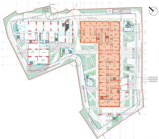
Hình 1. 14. Sơ đồ mặt bằng tầng 1 bố trí thương mại dịch vụ (shophouse)
