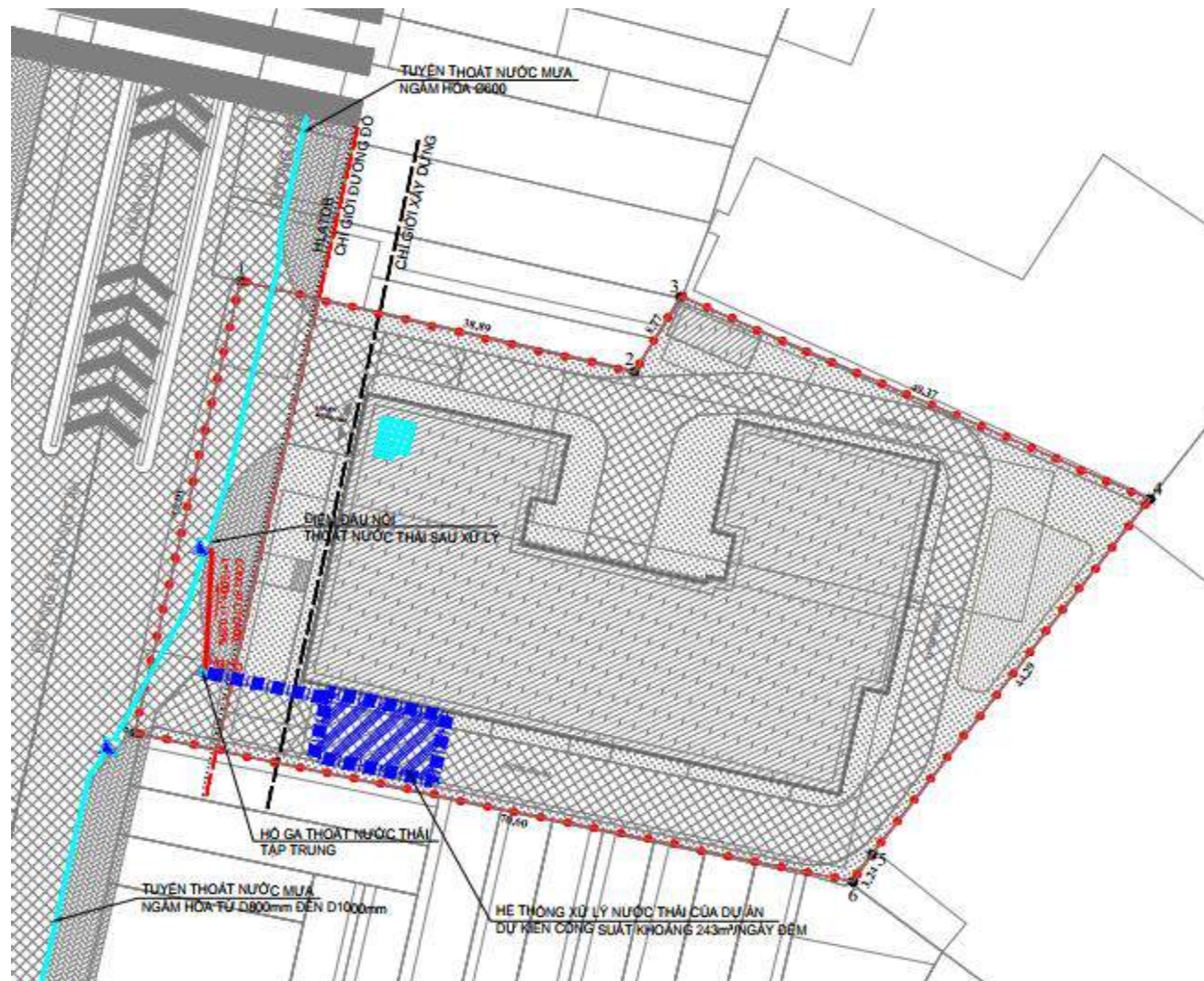
Hình 4. 6. Vị trí xây dựng hệ thống xử lý nước thải, công suất 243m 3 /ngày.đêm
