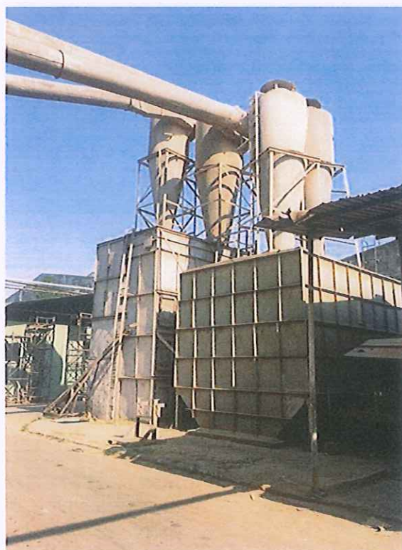
Hình 3.12. Hệ thống xử lý bụi chà nhám PU và khu vực gia công, tinh chế
