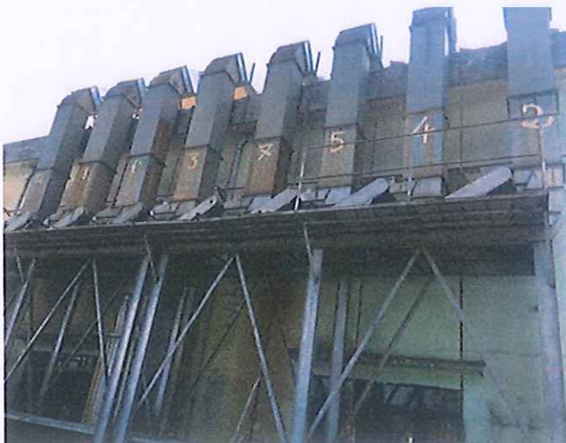
Hình 3. 16. Hệ thống xử lý hơi dung môi sau hệ thống sơn bằng màng nước
