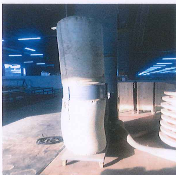
Hình 3.14. Hệ thống xử lý bụi tại khu tạo phôi và gia công tinh chế
