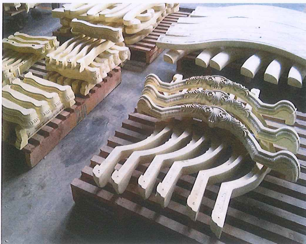
Hình 1.5. Chi tiết hoa văn đúc bằng khuôn.
