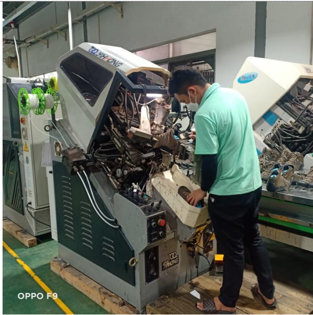
Hình 1.21. Công đoạn ép nhiệt
