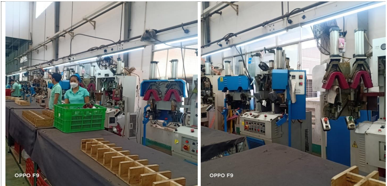
Hình 1.15. Công đoạn ép gót và mũi giày
