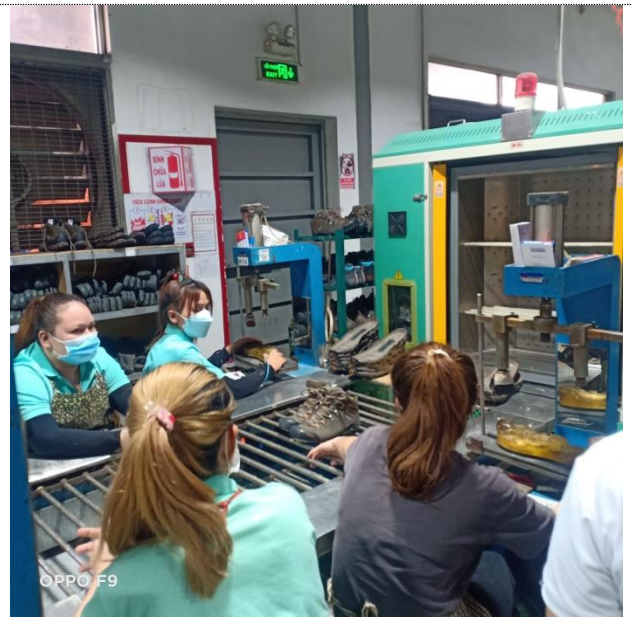
Hình 1.24. Công đoạn kẻ định vị
