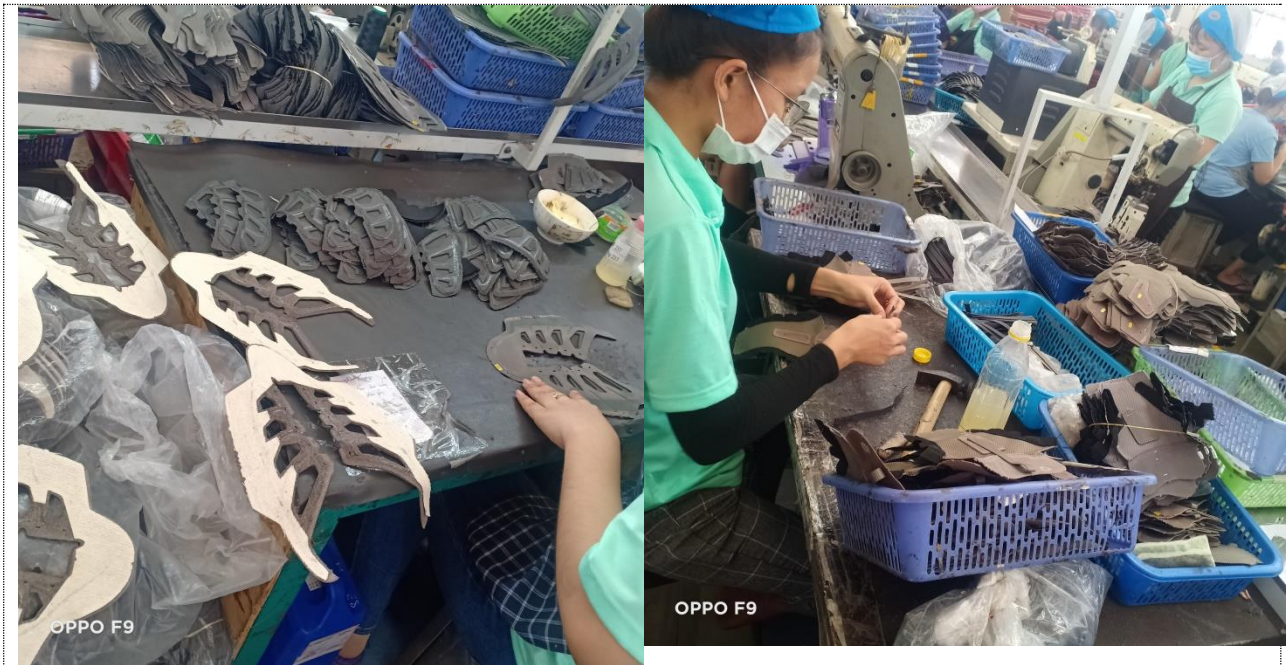
Hình 1.9. Công đoạn dán các chi tiết lại với nhau
