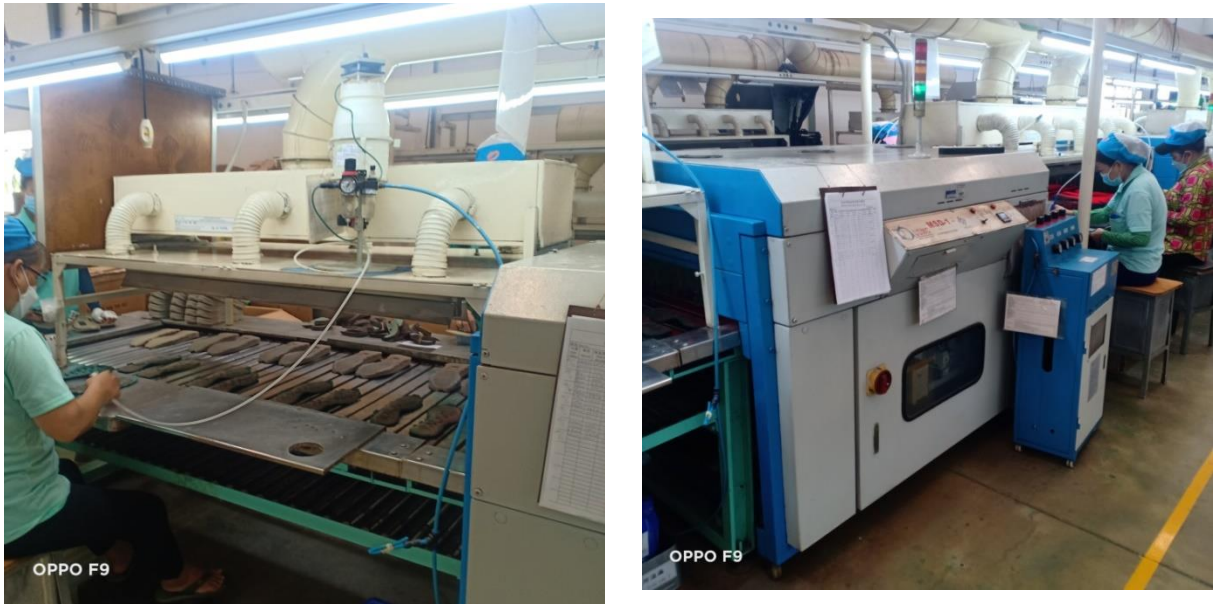
Hình 1.4. Quét chất xử lý và sấy
