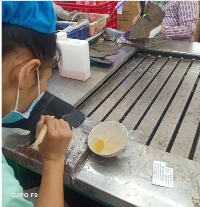
Hình 1.11. Công đoạn quét chất xử lý khử dầu
