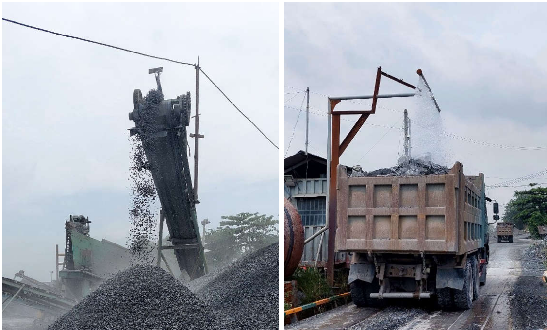
Hình 3.7: Hệ thống phun sương dập bụi tại cần xuất sản phẩm đá sau xay, và xe chở thành phẩm tại trạm cân trước khi ra khỏi mỏ
