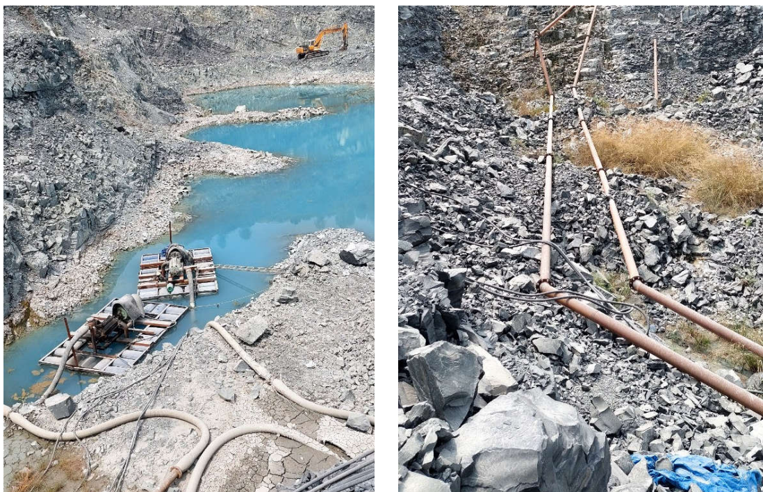
Hình 3.3: Hình ảnh hồ nước trong moong khai thác, và đường ống thép dẫn nước lên phía trên của moong, về ao lắng
